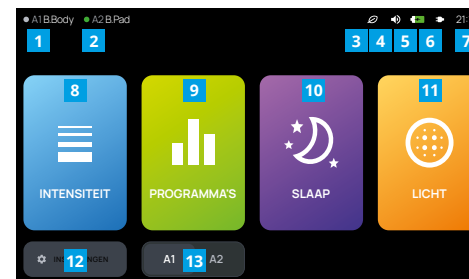
Hoofdmenu van de B.Box Evo met voorbeeldweergave van alle informatie- en bedieningselementen
