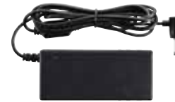
Externe medische voeding B.Box Evo (2MOPP) voor de voedingsspanning van de B.Box Evo
